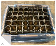
Nachher: Die Motorgehäuse werden durch ein Gefache aus VCI-Vollpappe voneinander gertrennt, so dass keine Abriebwirkungen entstehen können.
