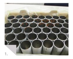
Vorher: Die Motorgehäuse stehen ungetrennt in einem KLT. Dadurch entstehen Schäden durch Reibung.
