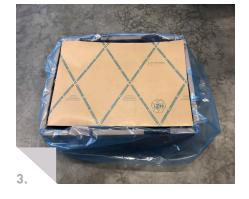
Eine Zwischenlage aus VCI-Pappe bietet zusätzlichen Korrosionsschutz. Die VCI-Folie, mit der der KLT ausgeschlagen ist, wird zum Schluss zugeschlagen und verschlossen.
